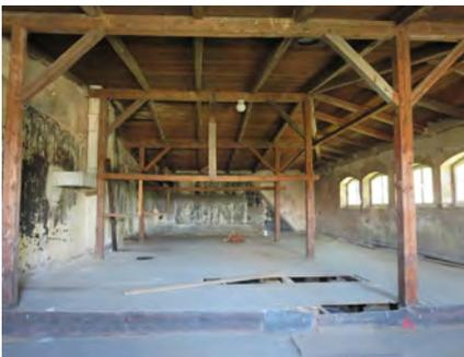
Aus bautechnischer Sicht besteht Handlungsbedarf in Bezug auf die Dachabdichtung und Dämmung, die Trockenlegung und Drainage der Wände sowie in Bezug auf die Instandsetzung / Erneuerung der technischen Infrastruktur. Die dichten Fenster stellen ein deutliches Problem für den derzeitigen Bestand dar. Die eindringende Feuchtigkeit kann nicht entweichen. Es bedarf daher nach einer Dämmung einer Entfeuchtung des Gebäudes.
